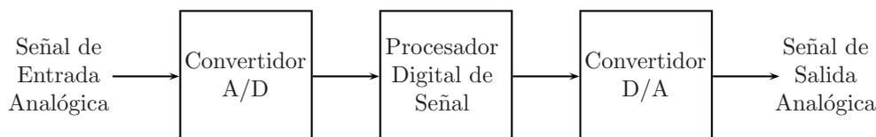
**Figura 1.2:** Procesamiento digital de una señal analógica [15].
